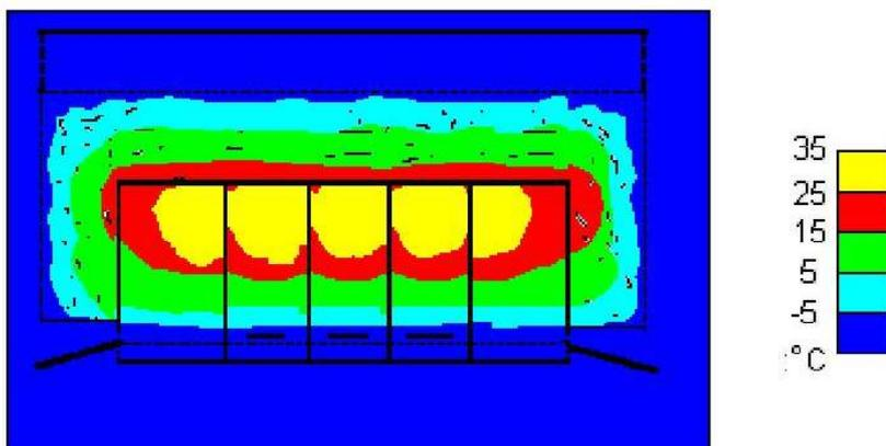
Рис. 5. Сверхутепленный многоместный любительский улей лежак. Схема распределения температуры по системе в конце зимовки (сечение через расплодные гнезда).
